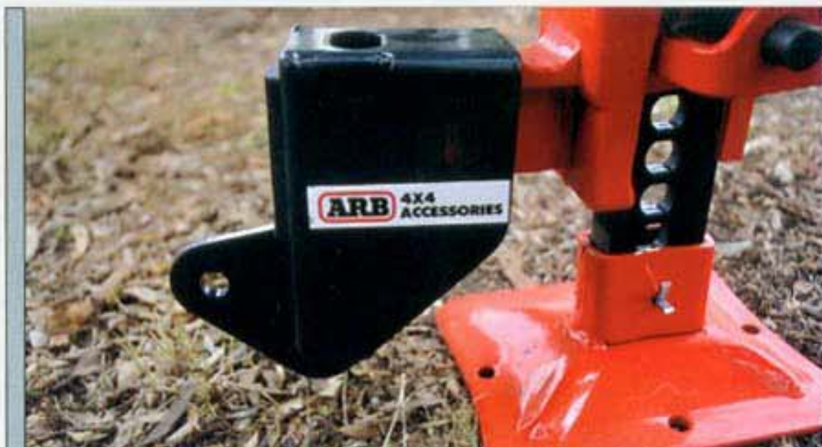
你可以买到各种的固定支点配件,图中这个就可以安装在一些ARB的前杠上。
