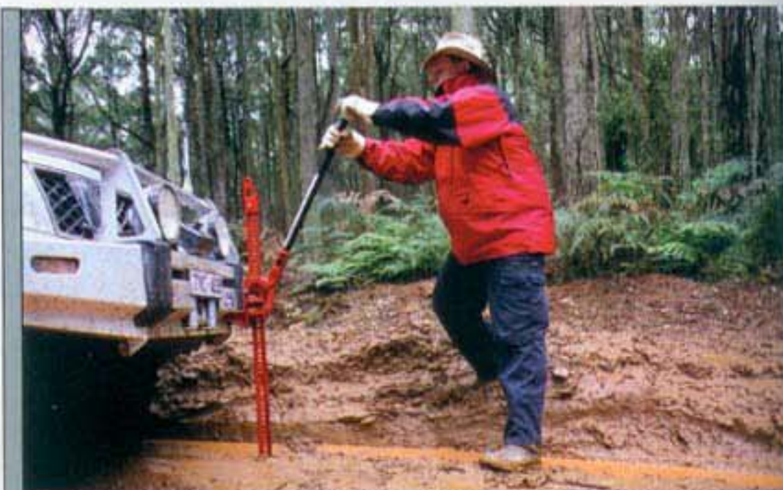
当你降下千斤顶时,使你的头部远离摇柄——别靠在摇柄上方。
